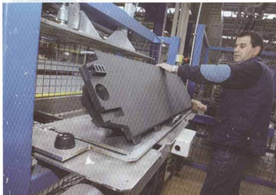
Un module de piscine Magiline à la sortie d'une presse
